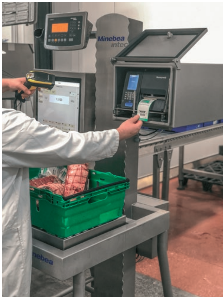
System ważąco-etykietujący WPL-S z ekranem dotykowym, skanerem i drukarką.
