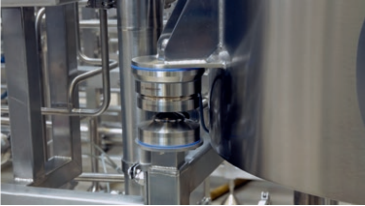
Dzięki modułowi wagowemu Novego® o higienicznej konstrukcji, bardzo małe ilości mogą być dozowane z dokładnością do grama ze zbiorników o pojemności kilku ton.
