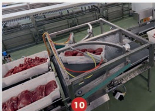
10 WEWNĄTRZZAKŁADOWY TRANSPORT POJEMNIKÓW
