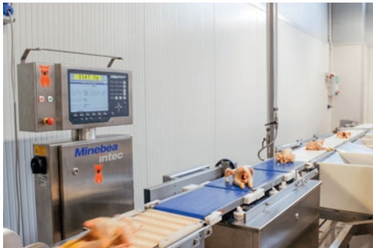
System ważenia i sortowania EWK 3010 oferuje standardową przepustowość na poziomie ponad 100 sztuk na minutę w G Valle Spluga SpA.
