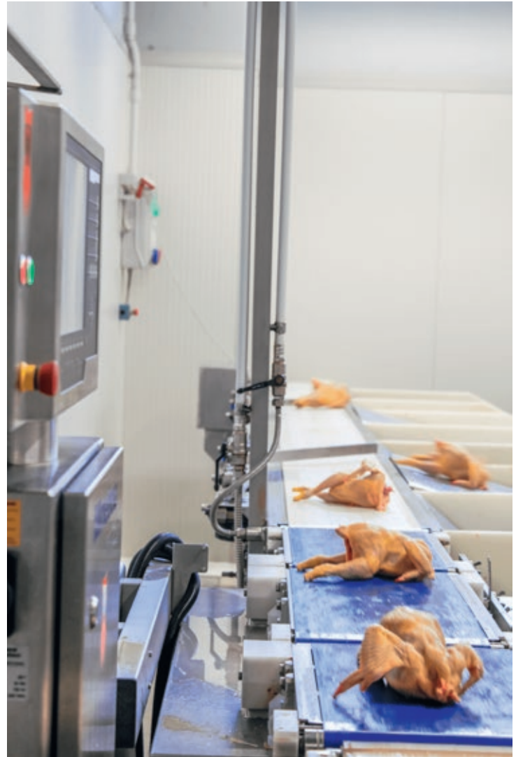
Sześć punktów sortowania jest zdefiniowanych w krokach co 50 g, dzięki czemu mięso drobiowe jest precyzyjnie klasyfikowane.
