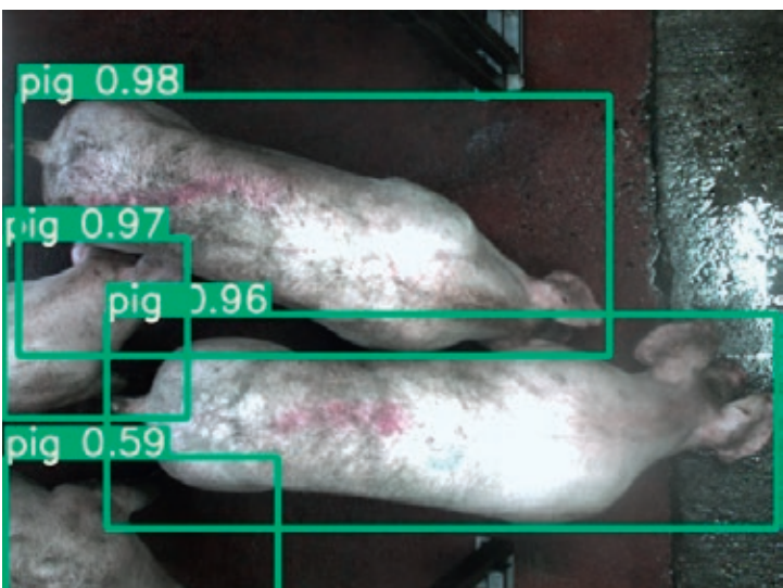
Zliczanie żywca przyjmowanego do zakładu także może być realizowane w sposób automatyczny. Kamery przemysłowe zamontowane nad wejściem skutecznie liczą poszczególne sztuki. Dane są natychmiastowo cyfryzowane i mogą trafić od razu do nadrzędnych systemów zarządzania produkcją.
